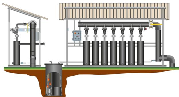
Conecta pozos o líneas de captación de biogás horizontales, se utiliza para ajustar el flujo de biogás y comprobar la calidad de cada línea de entrada. Está equipado con válvulas de regulación de flujo y un sistema de descarga de condensado compartido por todas las entradas situadas en la salida del colector principal.
