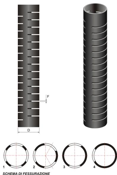
Tuberías de HDPE ranuradas y ciegas diseñadas para recoger y transportar el lixiviado y el biogás de los vertederos, así como el drenaje en las obras de construcción.
