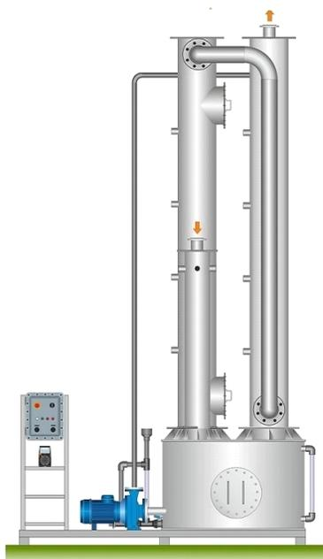
Les unités de traitement par voie humide du biogaz UTB sont la solution de base pour les installations de petite et moyenne capacité et sont utilisées comme système de réduction de certains contaminants typiques tels que le sulfure d'hydrogène (H<sub>2</sub>S). Le biogaz est lavé avec une solution d'eau et de NaOH, dans un processus qui se déroule en deux phases : prémélange en entrée et contact prolongé dans la tour de lavage.
