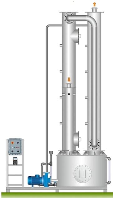
Las unidades de tratamiento húmedo del biogás UTB son la solución básica para plantas de capacidad media-pequeña y se utilizan como un sistema para reducir algunos contaminantes típicos, como el sulfuro de hidrógeno ( $H_2S$ ). El biogás se lava con una solución de agua y NaOH, en un proceso de dos pasos: premezcla en la entrada y contacto prolongado en la torre de lavado.
